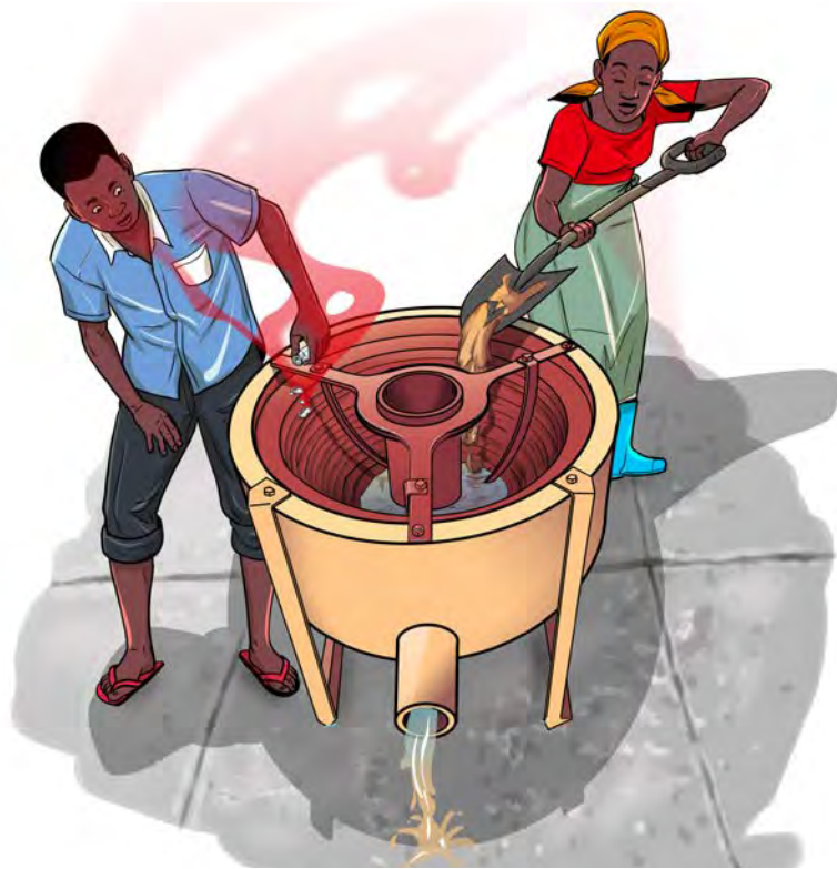
Image 15 : Une pratique dangereuse consiste à ajouter du mercure aux concentrateurs centrifuges.
