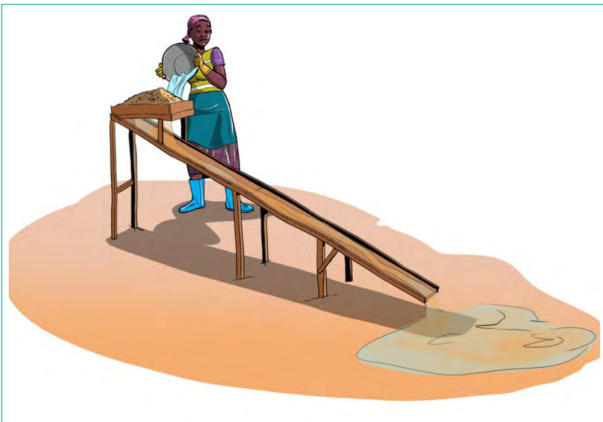
Image 23 : Lavage à l'écluse.
