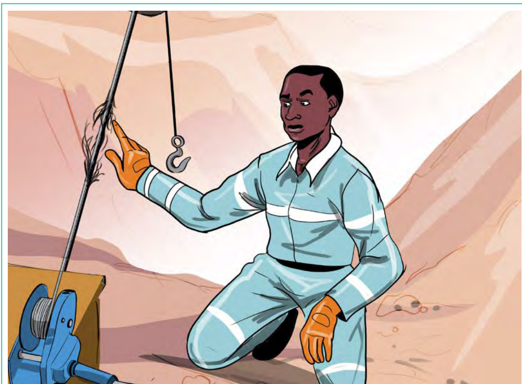
Image 15 : Vérifier s'il y a des bris dans le câble de levage du treuil et le remplacer immédiatement le cas échéant.
