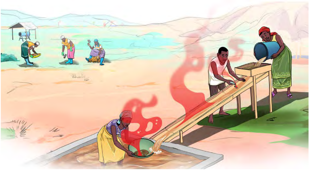
Image 1 : Une pratique dangereuse consiste à ajouter du mercure au tapis d'une rampe de lavage.
