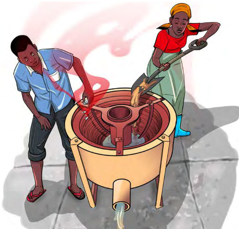
Image 2 : Une pratique dangereuse consiste à ajouter du mercure aux concentrateurs centrifuges.
