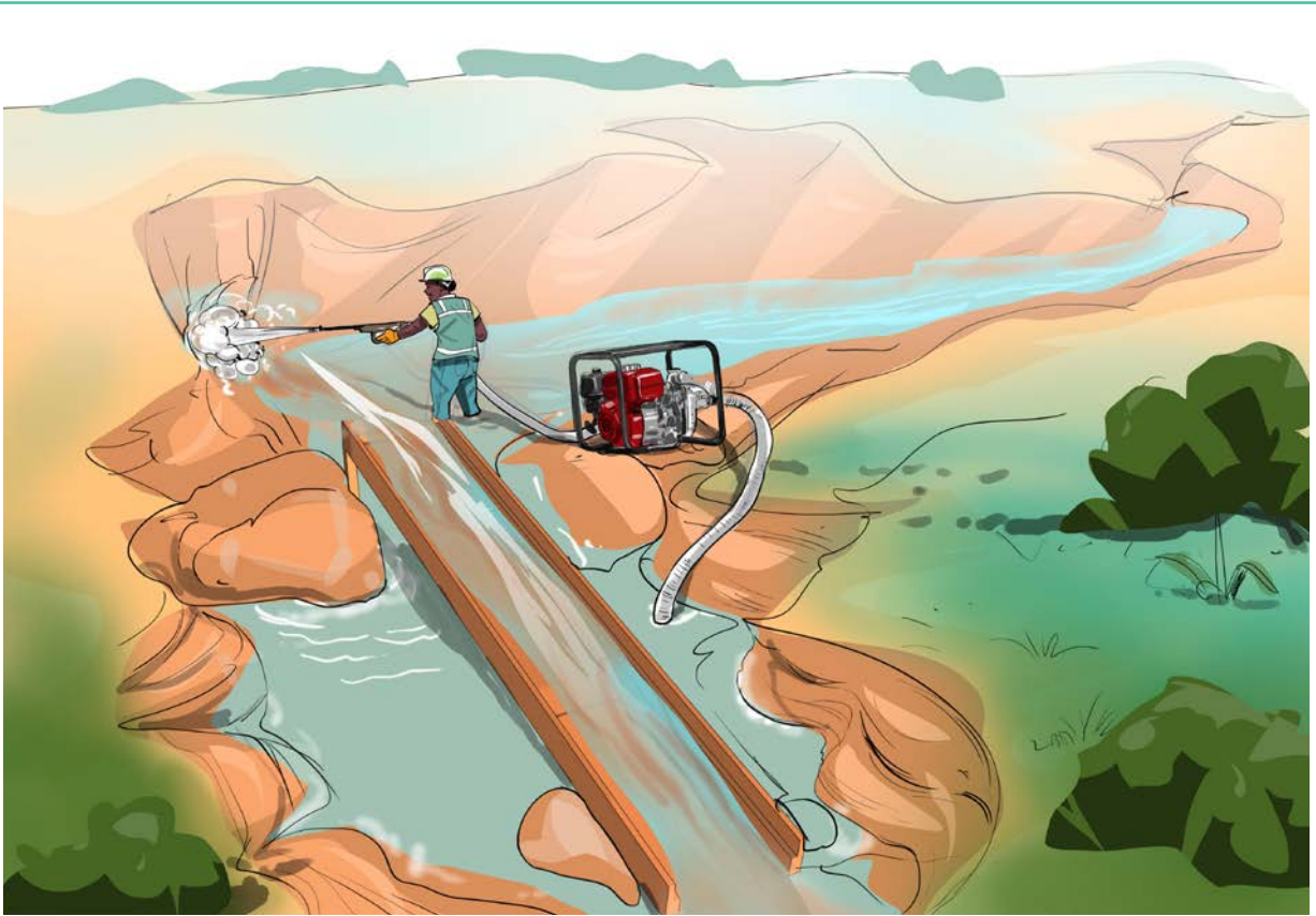
Image 30 : Une motopompe est utilisée pour rompre le sol.
