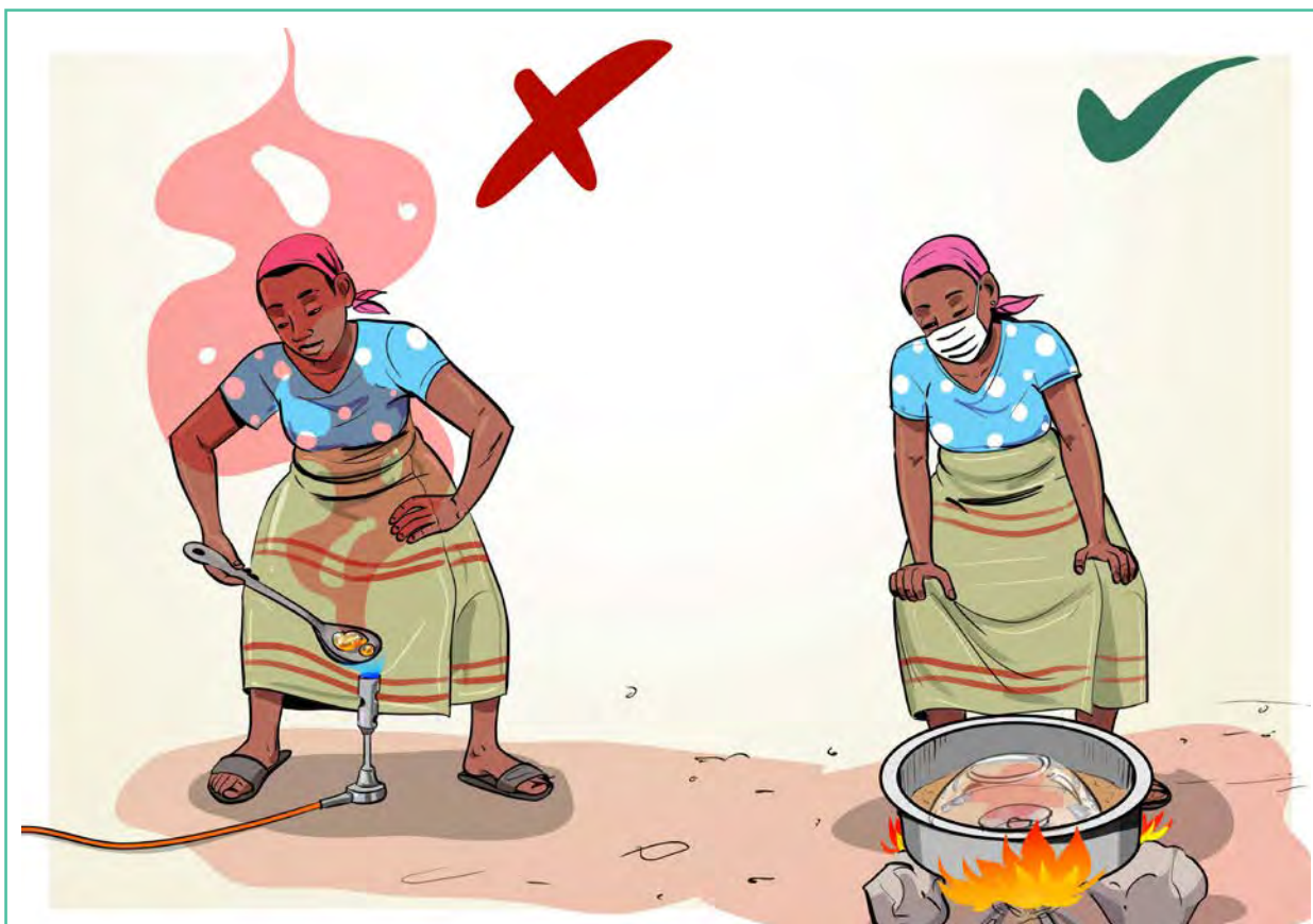
Image 14 : Portez un masque et utilisez une cornue lorsque vous brûlez de l'amalgame.
