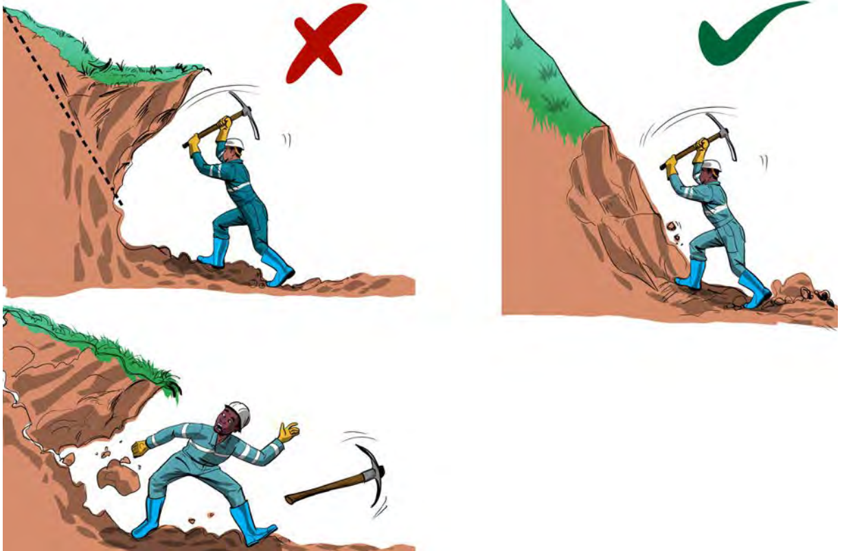
Image 8 : Pour prévenir les accidents, l'exploitation minière doit se faire correctement sans laisser de paroi abrupte ni de sous-cavage.
