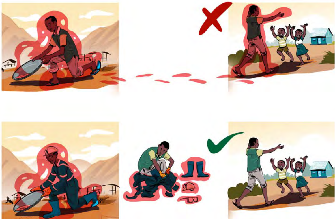
Image 6 : Vêtements de protection pour empêcher le mercure de contaminer les vêtements habituels.
