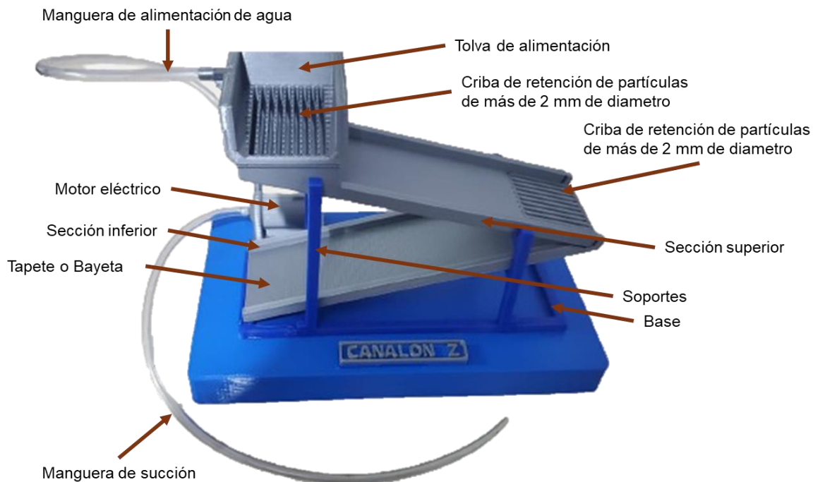
Imagen 2. Partes de un canalón Z Fuente: planetGOLD, Colombia
