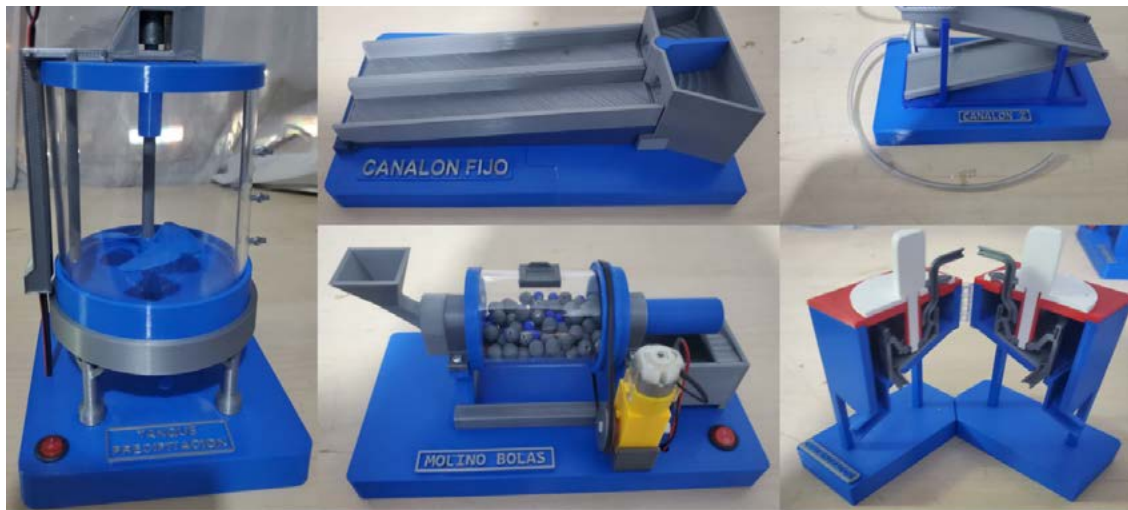
Figura 6: Equipo 3D para capacitar a mineros de pequeña escala como parte del proceso de capacitación de planetGOLD Colombia "Conozco mi planta" (tanque agitador, canalón fijo, canalón móvil, molino de bolas, concentrador centrífugo)
