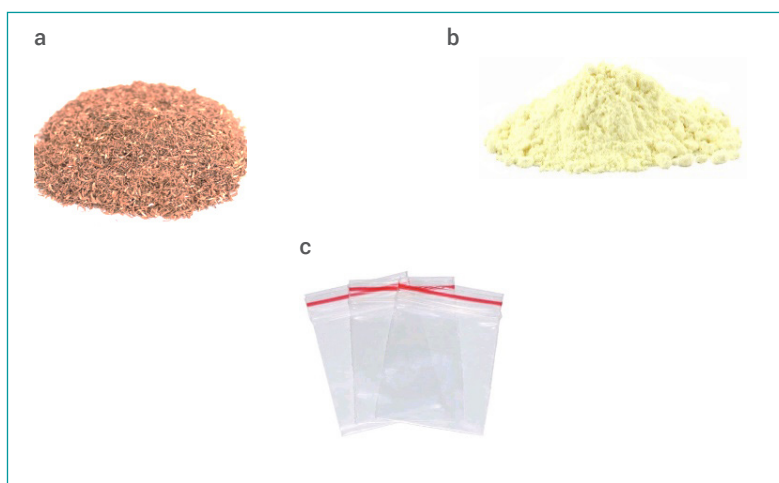
Figura 14. Materiales de supresión de derrames y vapores: a) virutas de cobre; b) polvo de azufre; c) bolsas de plástico sellables
