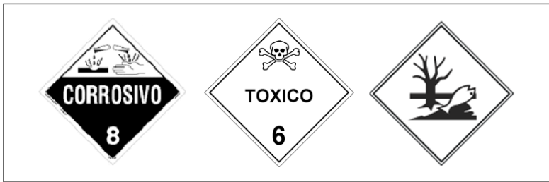
Figura 16. Paneles que se exhibirán en un vehículo de clase 8 (6.1): Corrosivo clase 8, clase 6.1 Tóxico, pictograma “pez y árbol”.
