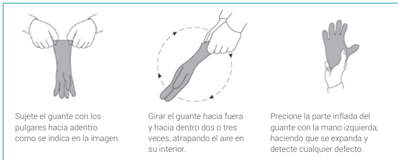
Figura 11. Prueba de guantes de goma o sintéticos para detectar orificios u otras fugas.
